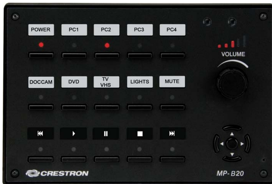
Kuva 10: Opetustilan F158 painikepaneeli, joka on upotettu opettajan pöytään. Toinen vastaava paneeli on sijoitettu laitevaunuun tilan etukulmaan.
