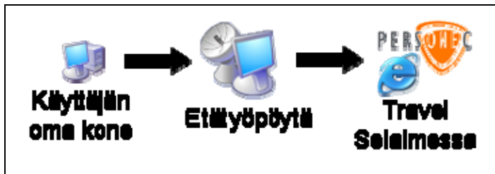
Kuva 2. Travel-järjestelmän käytön tekninen ratkaisu TKK:lla. Käyttäjän koneelta otetaan yhteys etätyöpöytään, jossa järjestelmä toimii verkkoselaimessa.
