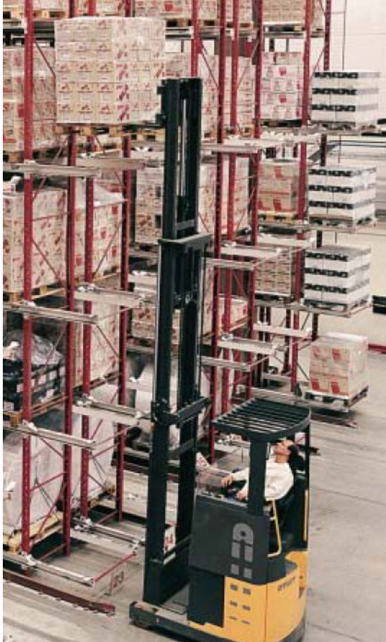
Kuva 2 (vasemmalla): Työntömastotrukki nostaa lavallisen tavaraa hyllylle. Kuvan lähde: Truckinformatik (Bark, Bolin 2004)
