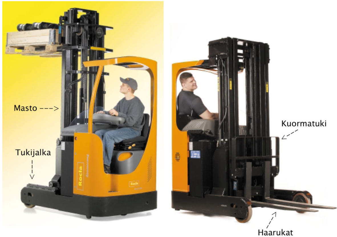
Kuva 1: Roclan uusin tuotannossa oleva työntömastotrukkimalli, Rocla Boomerang. Alkuperäiset kuvat Roclan www-sivuilta osoitteesta www.rocla.com .
