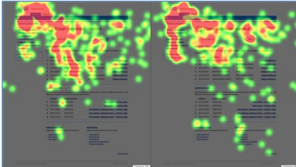
Kuva 30. Fiksaatioiden kohdistuminen sivun yläosaan viidentoista ensimmäisen sekunnin aikana (fiksaatioiden määrä). Kokemattomien arvioijien lämpökartta vasemmalla, kokeneiden vastaava oikealla.
