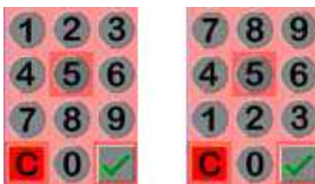
Kuva 7: Vasemmalla matkapuhelintyylinen numeronäppäimistö, jossa numerointi alkaa ylhäältä ja oikealla laskinmallinen numeronäppäimistö, jossa numerointi alkaa alhaalta (Waloszek, 2000).
