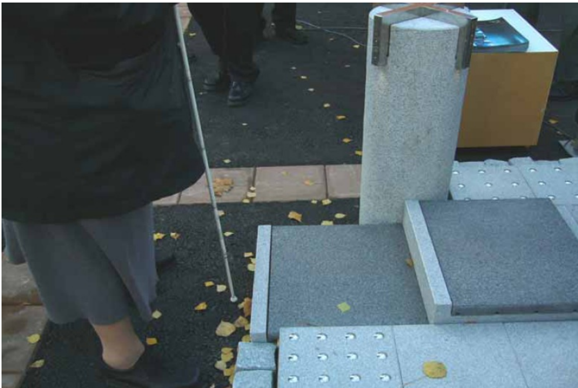
Kuva 3 Kaksiosainen kontrastiraidallinen porruselementti sekä kohokuvioituja opaslaattoja käyttäjätestauksessa. [15]
