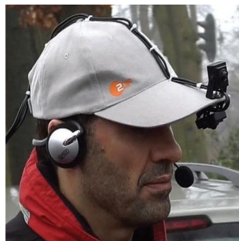
Kuva 2: Lippalakkiin kiinnitetyt kamerat (van Elzaker, ym. 2008)
